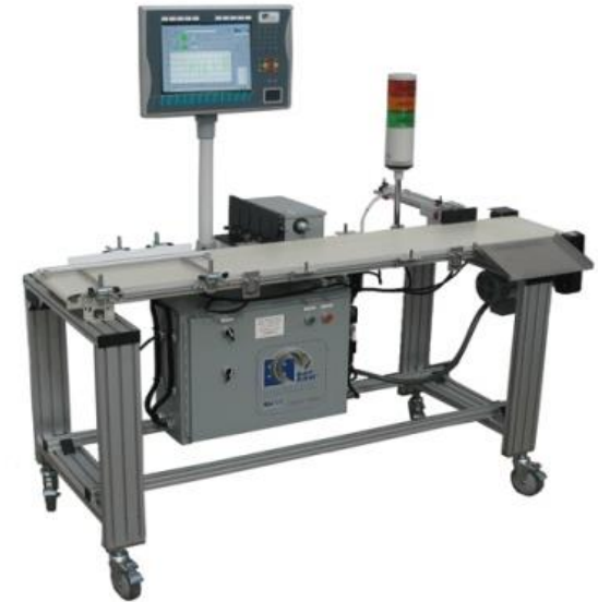
ระบบตรวจสอบคุณภาพชิ้นงานที่ เป็นโลหะโดยการใช้เสียง (NDT-RAM)
